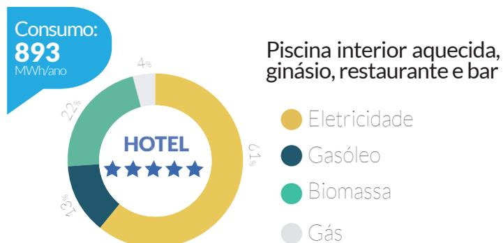
A energia elétrica tem o maior peso no perfil de consumo. O hotel utiliza gasóleo e biomassa no aquecimento de água (13 kWh/hóspede), com preferência pela biomassa. O gás butano é utilizado na preparação de refeições (2 kWh/refeição).
