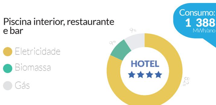
A energia elétrica tem o maior peso no perfil de consumo. O hotel utiliza biomassa no aquecimento de água (3 kWh/hóspede) e gás butano na preparação de refeições (1,1 kWh/refeição).
